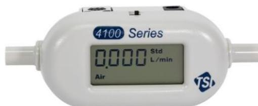
Диапазон: 0,01-20 л / мин. Калибровка: N<sub>2</sub> O, Воздух, O<sub>2</sub>, N<sub>2</sub>. Подключения: трубка 3/8 дюйма.
