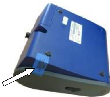
Рисунок 3 – Схема пломбировки анализаторов DUSTTRAK 8530 и DUSTTRAK 8533 от несанкционированного доступа
