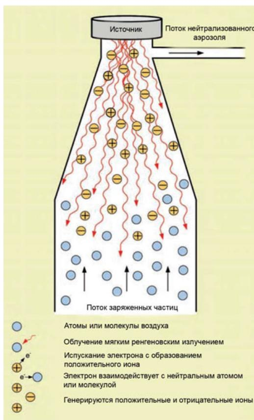
Принцип заряда за счет биполярной диффузии используется в нейтрализаторе аэрозолей модели 3088.
