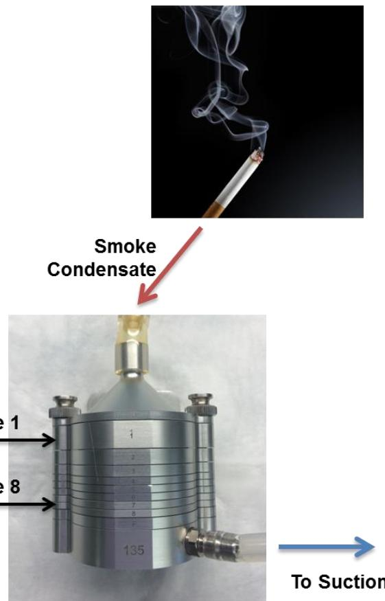
Наиболее крупные частицы в конденсате дыма осаждаются на подложке (кусок металлической фольги или фильтра) на этапе 1. Все более мелкие частицы улавливаются нижними ступенями. Выше показано восьмиступенчатое устройство. Типичные результаты с различными марками сигарет и электронных сигарет показаны ниже и показывают, что большая часть массы аэрозоля собирается на ступенях 4, 5 и 6 импактора с размером частиц от 0,4 до 1,3 микрометра.
