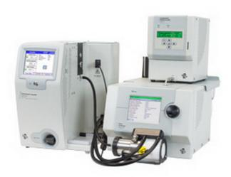
Спектрометры серии SMPS производства TSI широко используются в качестве эталона для определения распределения по размерам частиц аэрозоля диаметром менее 1 мкм. С применением дополнительно расширителя «нано» модели 3757 и анализатора дифференциальной подвижности модели 3086 (1 nm-DMA) нижний предел измерений для спектрометра SMPS удалось снизить с 2,5 до 1 нм.
