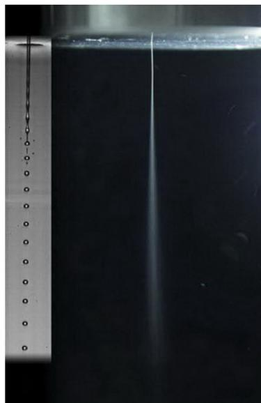
Диаметр сформированных капель управляется скоростью потока жидкости и частотой вибрации пьезоэлектрического керамического привода. Значение скорости потока может быть установлено между 1 и 100 мл/час с помощью шприцевого насоса с регулируемой скоростью. С пьезоэлектрическими колебаниями, установленными в пределах частоты 10 – 250 кГц, могут генерироваться однородные капли с диаметром 17 – 93 мкм.
