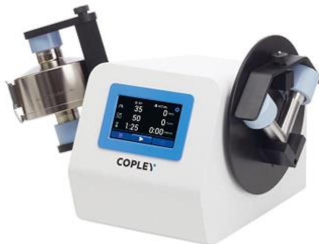
Блоки подготовки проб (SPU) обеспечивают быстрый и простой способ извлечения активного лекарственного средства из портов индукции и / или предварительных сепараторов во время тестирования APSD.
