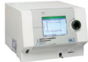
Водные: TSI предлагает линейку прецизионных водных конденсационных счетчиков в качестве альтернативы счетчикам с использованием спирта. Используя запатентованную технологию конденсации с ламинарным потоком эти изделия подсчитывают частицы с размером до 2,5 нм с концентрацией до 400000 частиц на см3, обеспечивая подсчет отдельных частиц.
