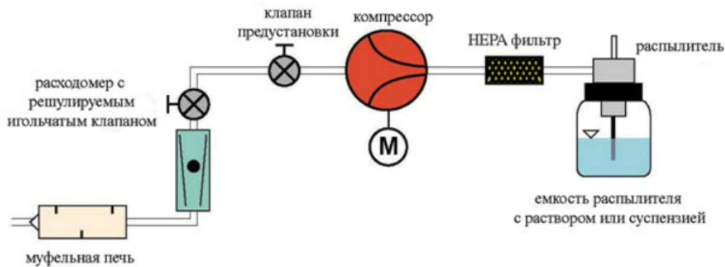
В генераторе используется распылитель со сжатым воздухом с инжекционной насадкой на 2 потока для генерирования полидисперсного аэрозоля. Сжатый воздух генерируется компрессором. Ротаметр с игольчатым клапаном позволяет установить расход воздуха. Оператор изменяет концентрацию частиц на выходе путем регулировки клапана.
